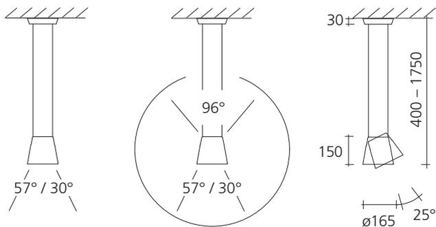
Direktlicht → umschalten → Direkt- und Indirektlicht
