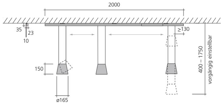
Abmessung Leuchte mit höhenverstellbaren
