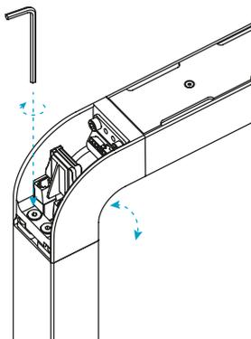
DE Richten Sie den Leuchtenkopf gerade aus und ziehen Sie die Schrauben mit dem Inbusschlüssel fest.
