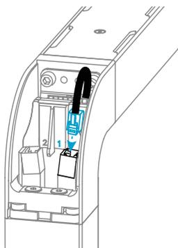
DE Stecken Sie den Modularstecker in die mit „1“ gekennzeichnete Buchse.
