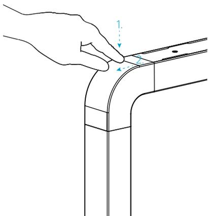
DE Entfernen Sie zur Demontage zunächst die gewölbte Abdeckung am Leuchtenkopf. Drücken Sie dafür vorsichtig auf die Abdeckung und ziehen Sie sie zu sich heran. Gehen Sie nun genau wie bei der Montage vor, bloß in umgekehrter Reihenfolge.
