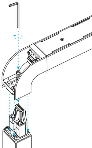
DE Setzen Sie den Leuchtenkopf auf den Schaft und ziehen die vier Schrauben leicht an.
