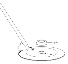
Das breitstrahlende Licht des Leuchtenkopfes ohne Optik mit 120° kann durch aufgesetzte Optike gebündelt werden.
