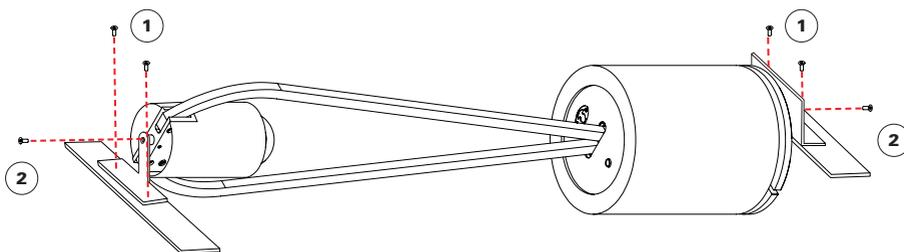
sollevare con cura in posizione verticale tenendo entrambe le estremità / gently lift the lamp vertically holding both ends
