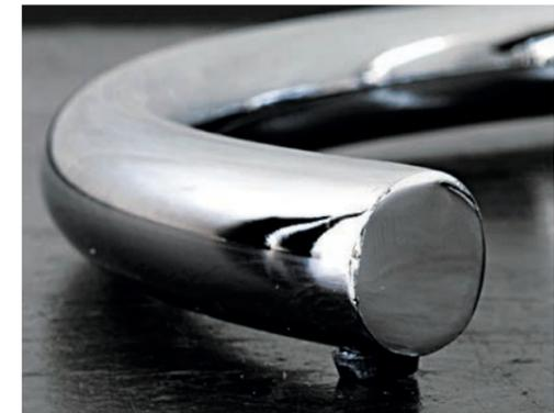
**UNTERTEIL** Am Unterteil lassen sich der Durchmesser und die Qualität der Stahlrohre gut vergleichen. Die stärkeren und kalt gewalzten Rohre des Originals sind sauber und scharfkantig geschlossen, die Oberfläche ist glatt und makellos verchromt. Die exakte und über ein spezielles Werkzeug gearbeitete Rundung des Unterteils gewährleistet ein völlig planes Aufliegen. Der Tisch hat einen festen Stand und wackelt nicht.
