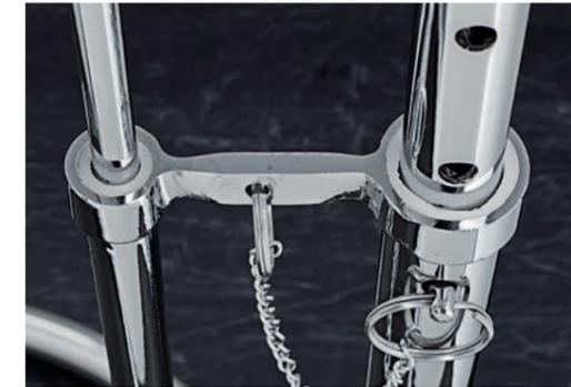
**STEG** Eine billige Schweißkonstruktion mit einem geraden Metallteil als Verbindung der vertikalen Stützen bietet keine ausreichende Stabilisierung, so dass der Tisch wackelt und in der Horizontalen schwingt.
