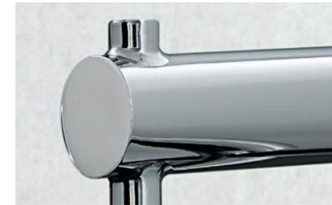
**VERBINDUNG GRIFF** Das durch die Glasplatte geführte Innenrohr des höhenverstellbaren Tisches ist hier durch das im Durchmesser grössere Stahlrohr des Griffs durchgesteckt und verschweißt, sauber geschliffen und verchromt. Diese Konstruktion trägt deutlich zur Stabilisierung des gesamten Rahmens bei.
