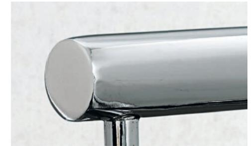
**VERBINDUNG GRIFF** Das Plagiat arbeitet hier mit einer wesentlich schwächeren Verbindung. Das Innenrohr wird ohne Durchführung und mit kleiner Verbindungsfläche an der Unterseite des Griffrohres angeschweißt.
