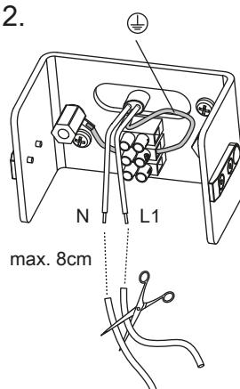
Schutzschläuche über die ganze Länge der Anschlußkabel überziehen.
