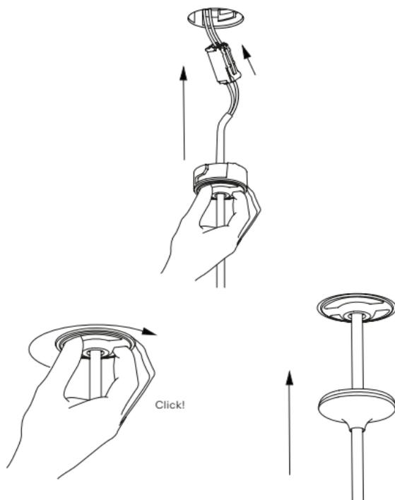
DE Über einen spürbaren Widerstand drehen. Beim Einsetzen der Leuchte nicht drücken. Nicht in die falsche Richtung drehen.
