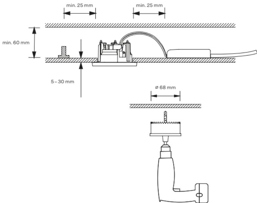
DE Sicherung ausschalten und Deckenblech anschrauben. (Die Auswahl der richtigen Befestigungsmittel liegt beim Installateur.)
