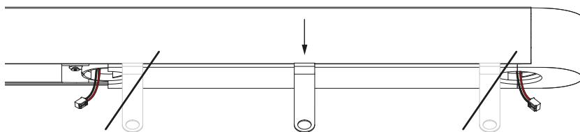
Plazieren Sie das Demontagewerkzeug in der Mitte der Abdeckung.
