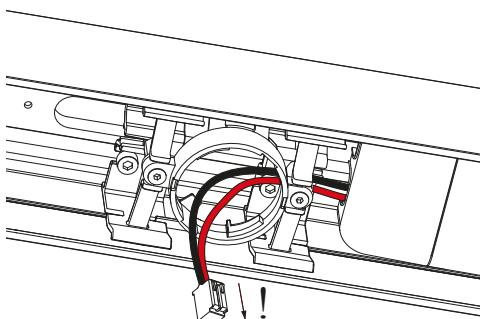
Bevor Sie die Abdeckungen anbringen, stellen Sie sicher, dass die Verbindungs-klemmen aus den Bajonettlöchern raus hängen.
