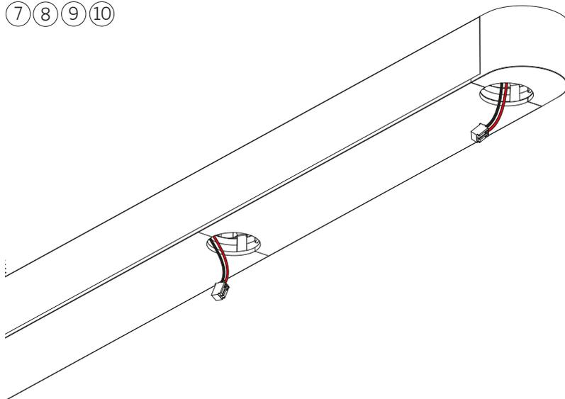
Abdeckung lösen • Remove the cover
